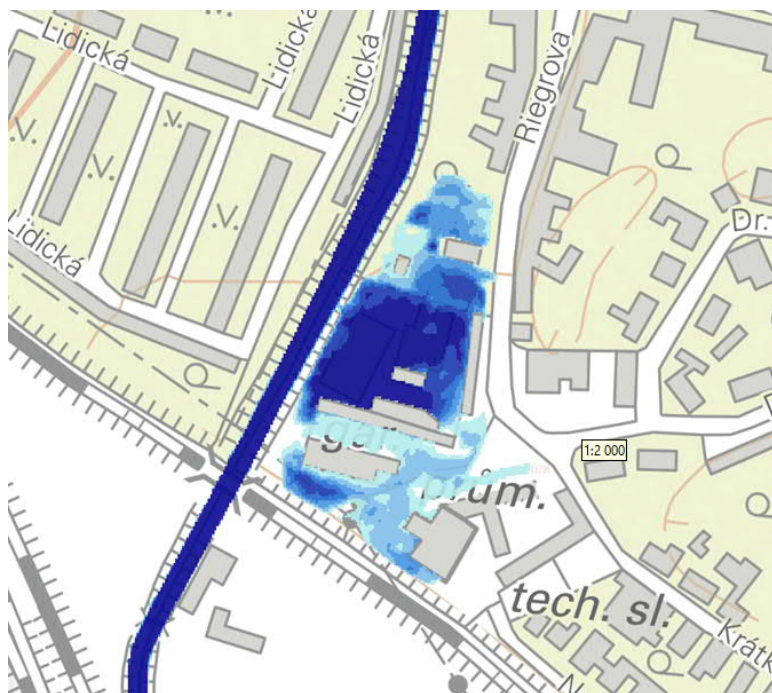
Obr. č. 5 Zatopené garáže na levém břehu po návrhu PPO
