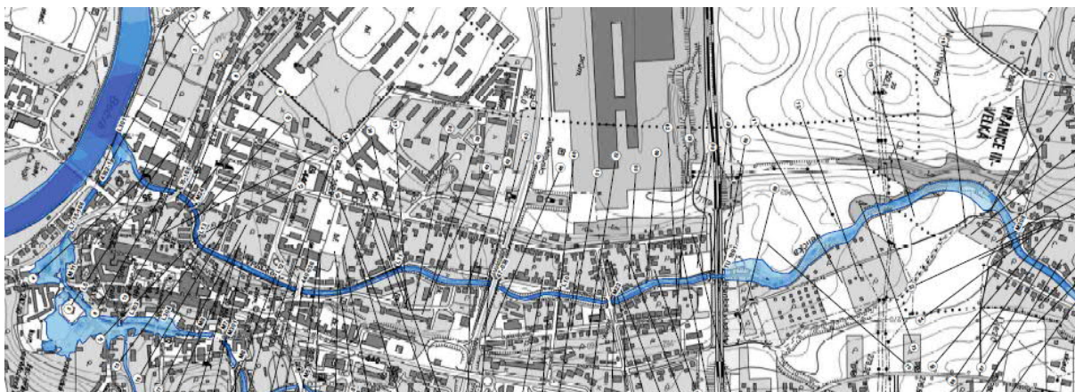
Obr. 3 - Rozlivy při průtoku Q_{100} (Velička cca km 0,000 - 3,168) po realizaci opatření dle studie [1]
