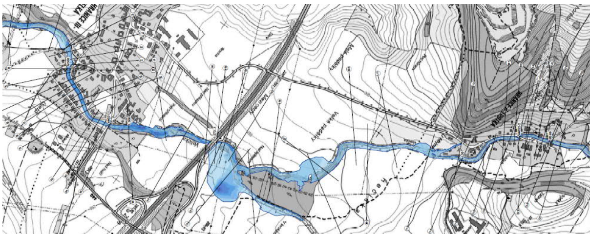
Obr. 2 - Rozlivy při průtoku Q_{100} (Velička cca km 3,168 - 6,202) po realizaci opatření dle studie [1]
