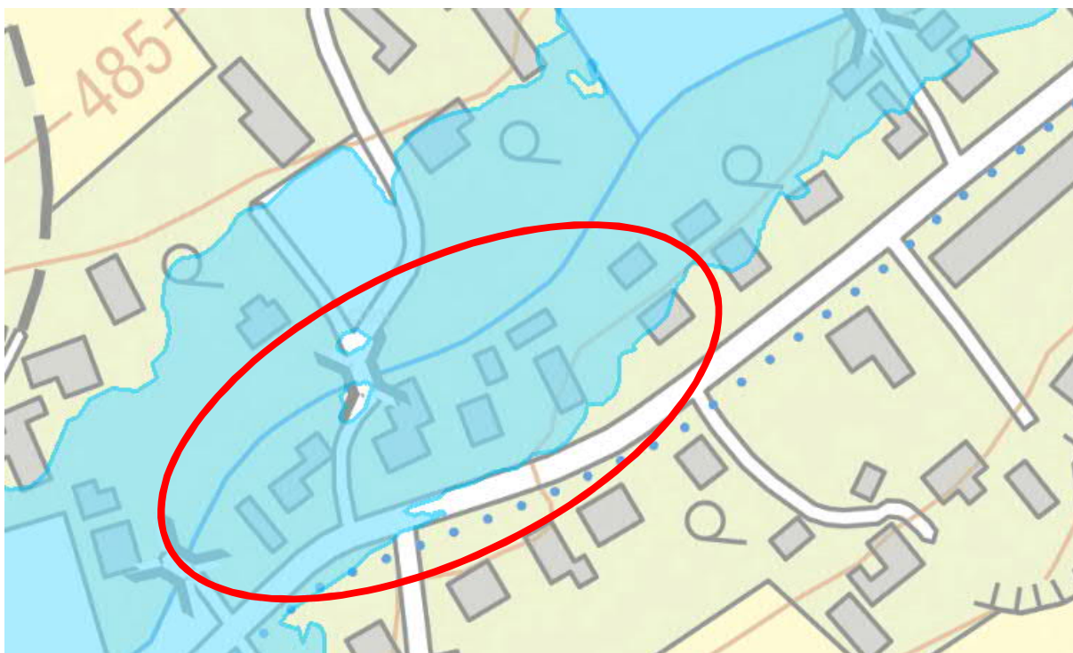
Obr. č. 6 levobřežní inundace pod zaústěním pravobřežního přítoku Proutník
