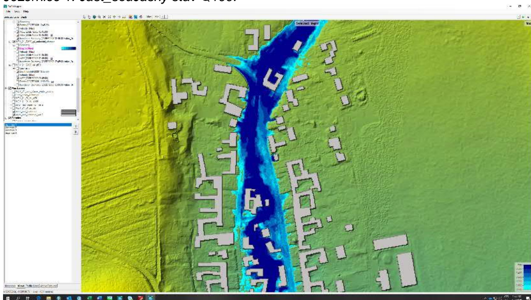
Jezernice 1. část_ Q100 po realizaci PPO:
